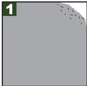
1 Antes de colocar el producto tenga su superficie de concreto ya colada, acomodada, vibrada, regleada, floteada y llaneada.
