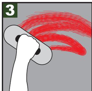
3 Una vez cubierta la superficie de concreto en fresco es necesario pulir con una llana manual o llanas tipo avión y repetir el proceso 2 en áreas donde aún se vea el gris del concreto y volver a pulir con las llanas, hasta lograr un color uniforme.
